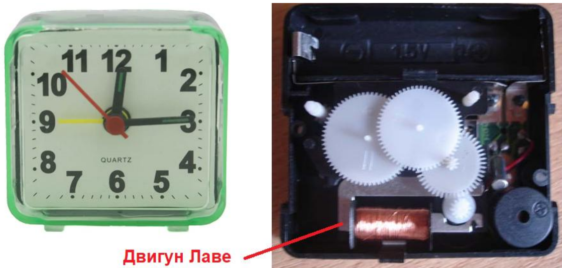
Рисунок 4 – Двигун Лаве в електромеханічному годиннику
