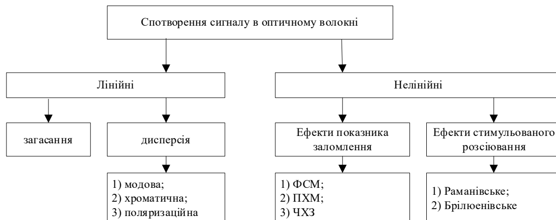
Рис. 1. Класифікація спотворень сигналу в оптичному волокні
