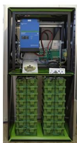
Накопичувач на основі натрій-іонних акумуляторів (2019 р)
