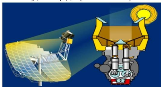
Сонячна електростанція потужністю 25 кВт (діаметр дзеркала – 13 м)
