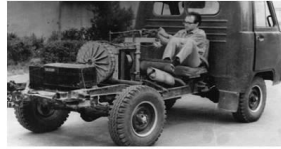
Автомобіль з супермаховиком (СРСР, 1960-ті роки)
