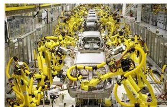
Автоматизована лінія зборки автомобілів з використанням роботів
