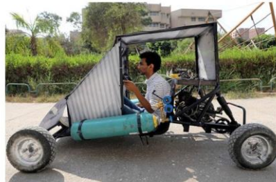
Пневматичний автомобіль студентів каїрського університету Хелвана (Helwan university)
