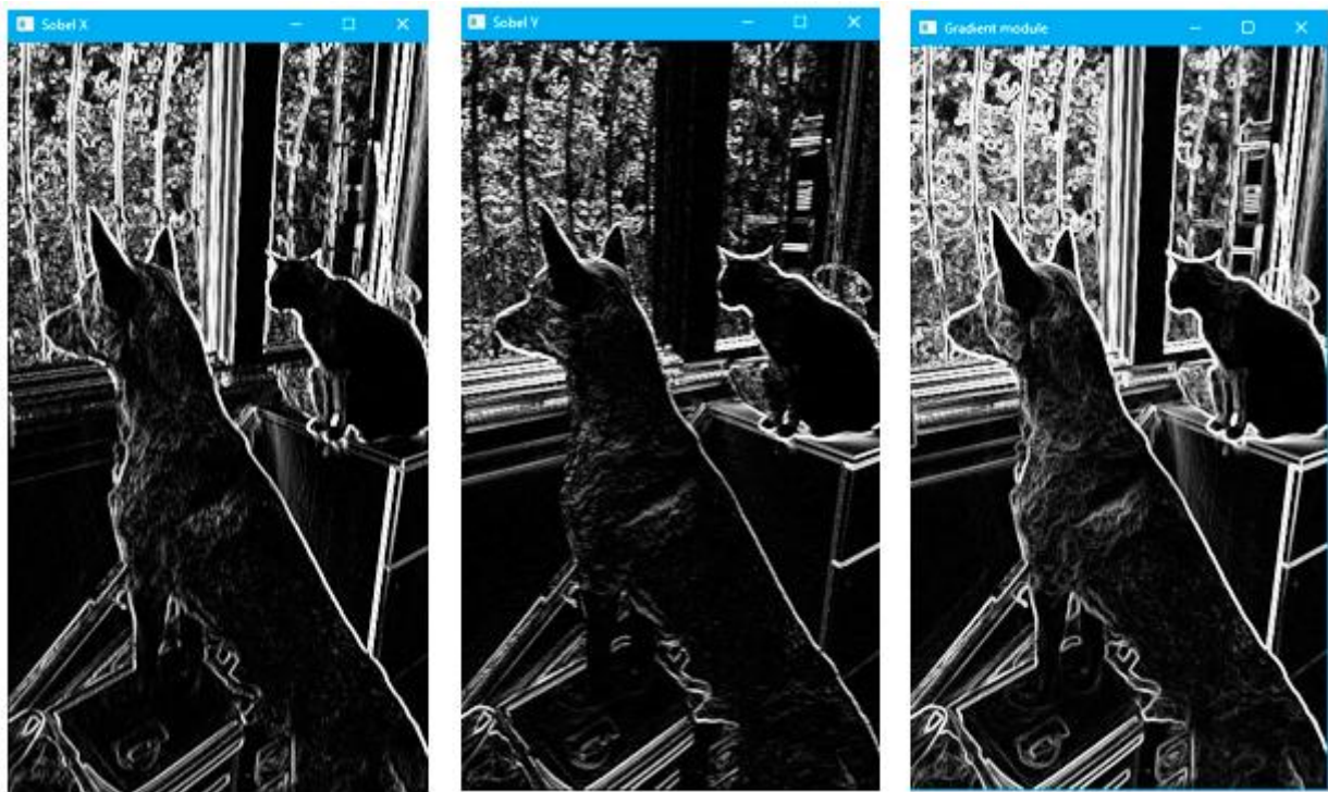
Рисунок 6.17. Результат виділення країв детектором Sobel а – виділення по осі x ; б – виділення по осі y ; в – модуль градієнта
