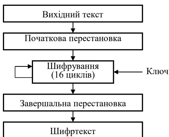
Рисунок 3.1 – Узагальнена схема шифрування в алгоритмі DES
