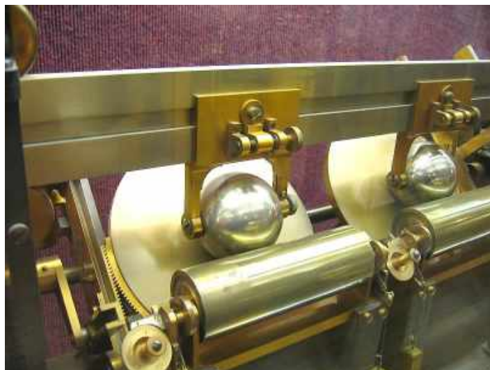
«Аналізатор гармонік» лорда Кельвіна, призначений для метеорологічних розрахунків
