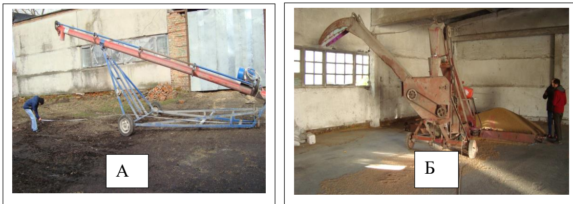
Рис. 6.28. Завантаження зерна у вантажний автомобіль гвинтовим перевантажувачем (А) за допомогою зерномета (Б)
