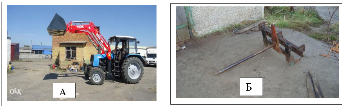
Рис. 6.30. Завантаження зерна у вантажний автомобіль за допомогою навісного обладнання до трактора з ківшом (А), а рулонів соломи – спец. штирем (Б)
