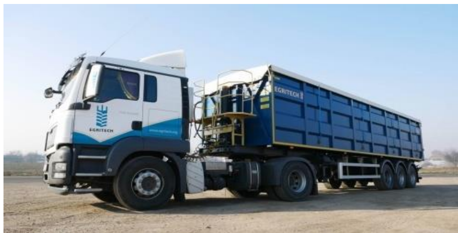
Рис. 7.11. Автозерновоз самосвального типу
