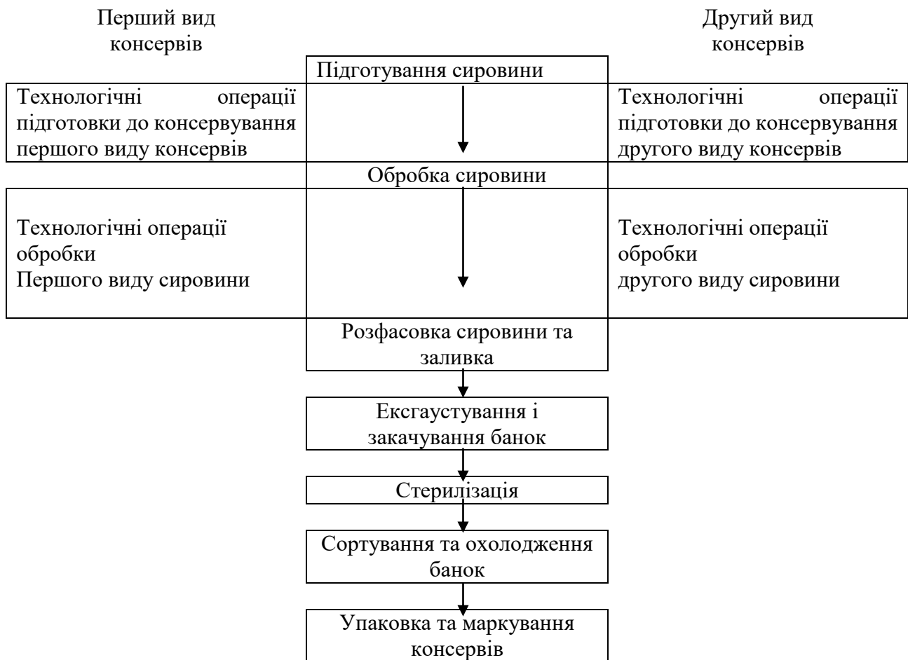
Рис. 7.2. Алгоритм виробництва різних видів консервів (у порівнянні)
