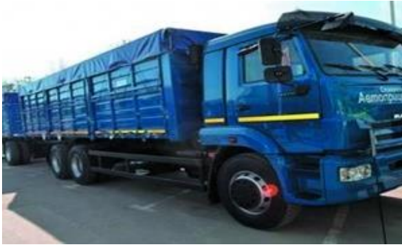
Рис. 7.13. Самоскид-зерновоз МАЗ-6501А8-325-000 із бічним розвантаженням праворуч і причепом МАЗ 856103-010
