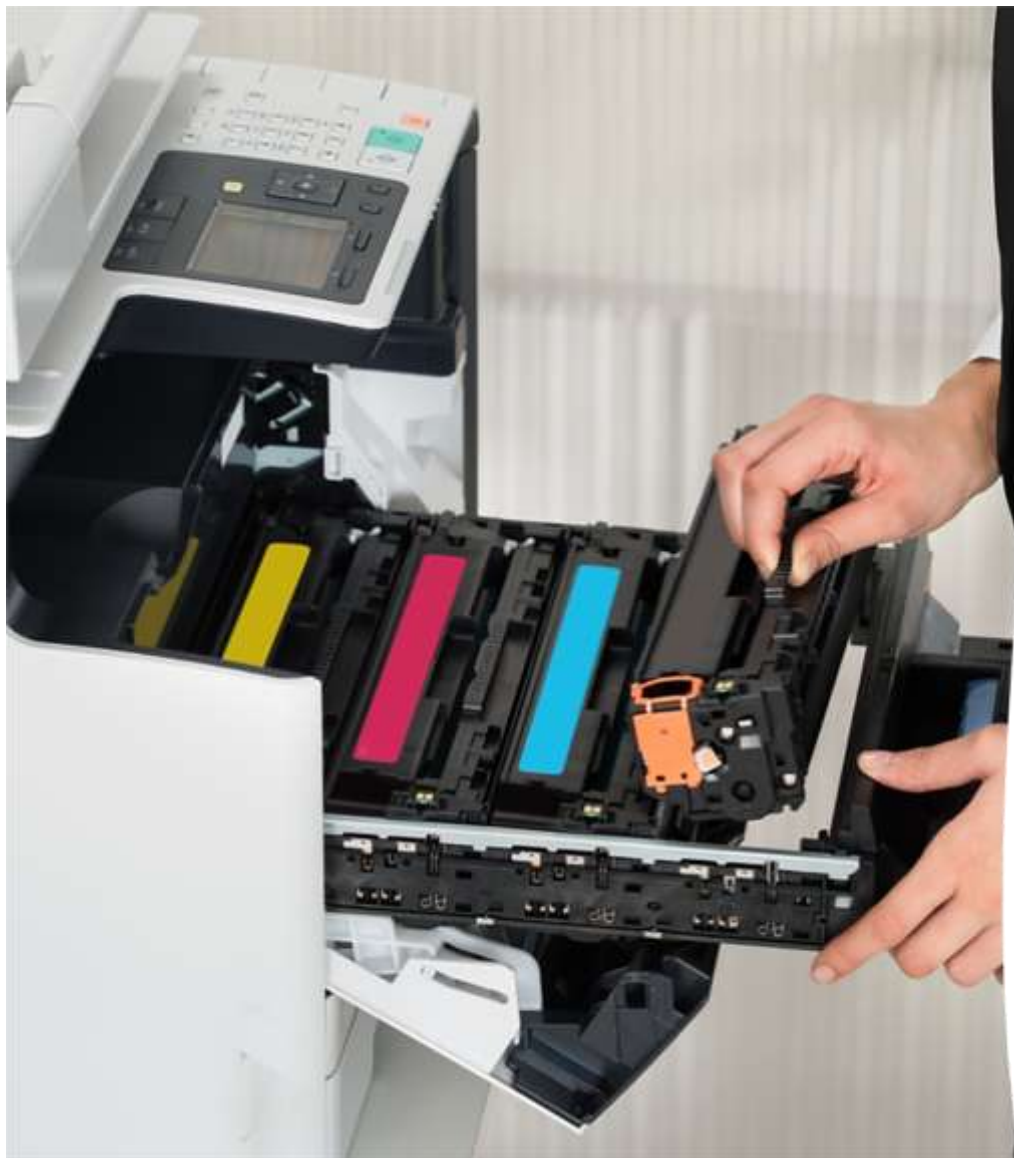
Установка в лазерний принтер картриджів із тонером чотирьох основних кольорів.
