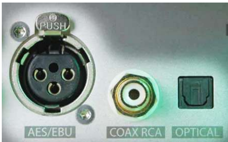
Три типи роз'ємів S/PDIF для підключення різних типів кабелів
