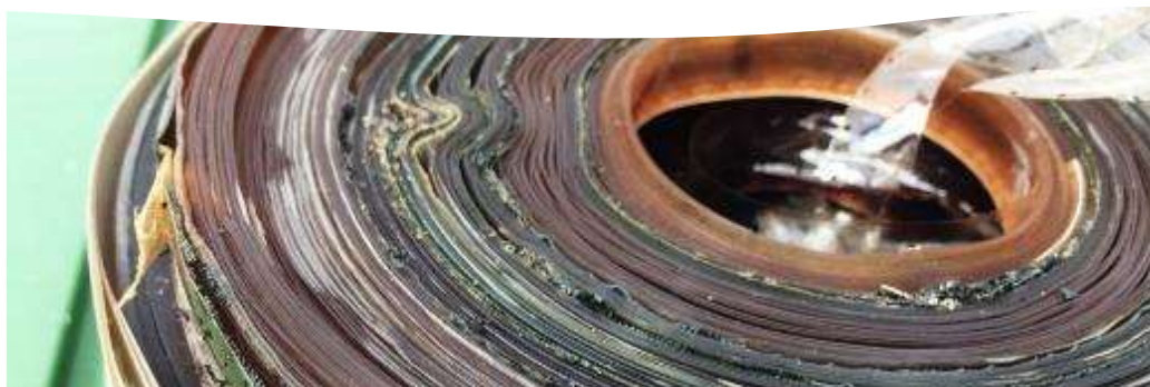
Деформація стрічки відеомагнітофона в разі тривалого зберігання
