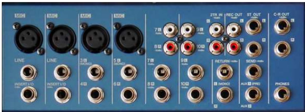
Роз'єми пульта MG10/2 для підключення мікрофонів та інших пристроїв
