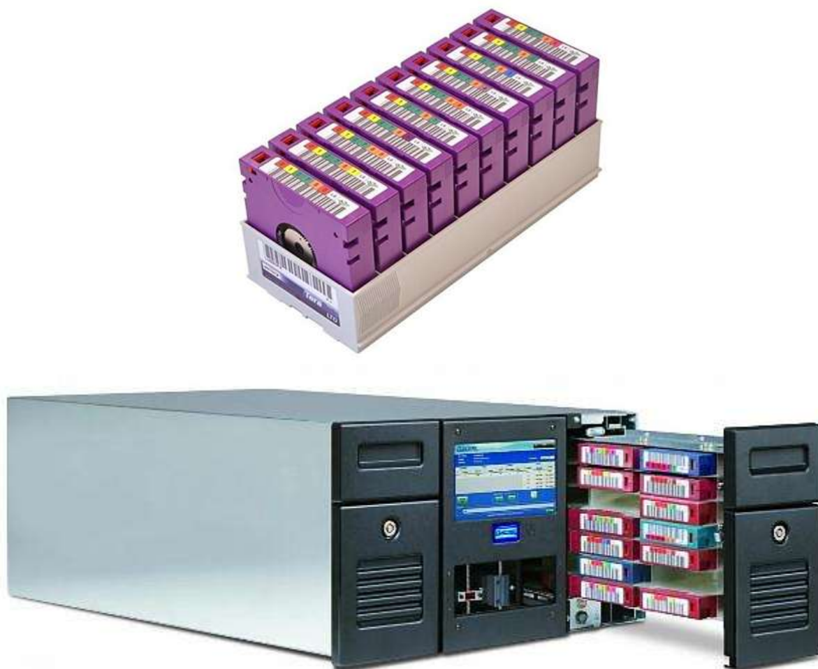
Стрічкова бібліотека та стример з автоматичною зміною картриджів
