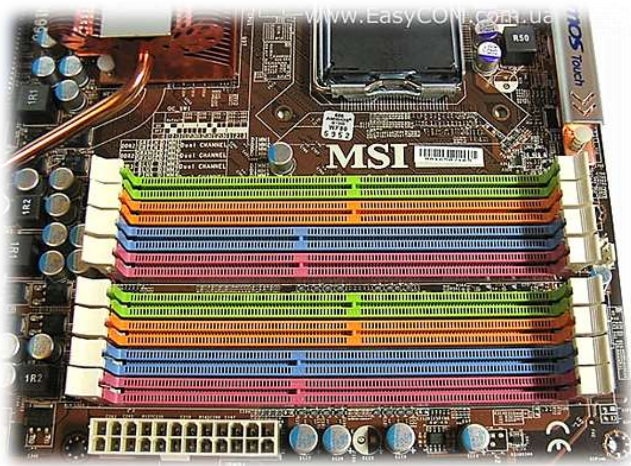
Роз'єми для встановлення в них модулів DIMM
