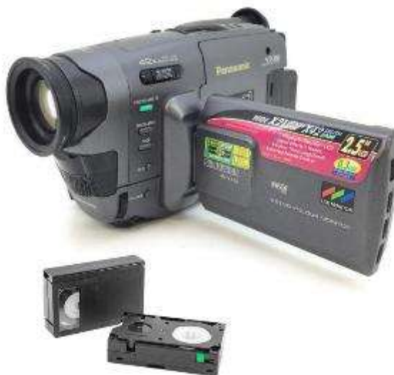
Компактний камкордер 1997 року та касети типу VHS-C до нього
