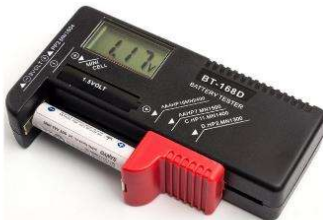
Кишеньковий універсальний тестер заряду батарейок BT-168D
