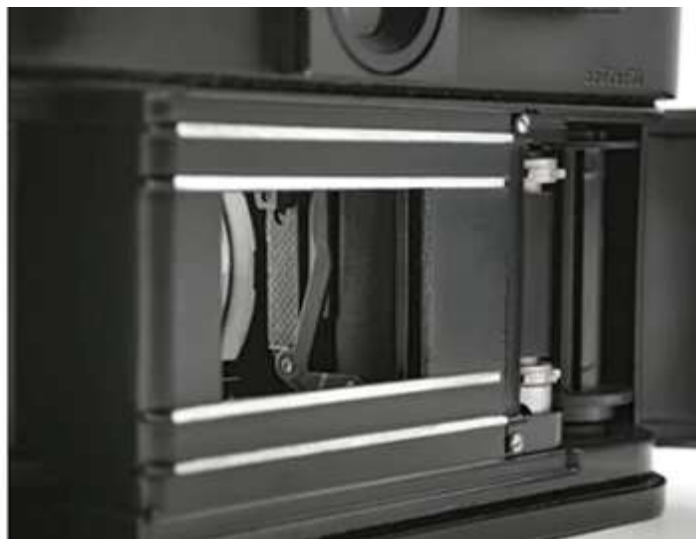
Фокальний затвор і принцип його дії
