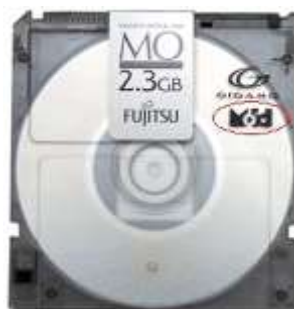
Магнітно-оптичний диск (не плутати його з компакт-дисками та CD-ROM!)
