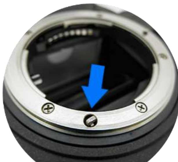
Байонет із системою механічної передачі від вбудованого в тіло фотокамери електромотора до об'єктива
