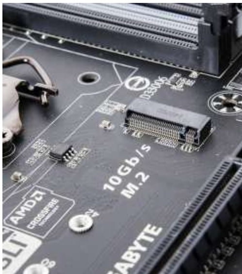
Роз'єм NVMe Express форм-фактору M.2 на материнській платі комп'ютера
