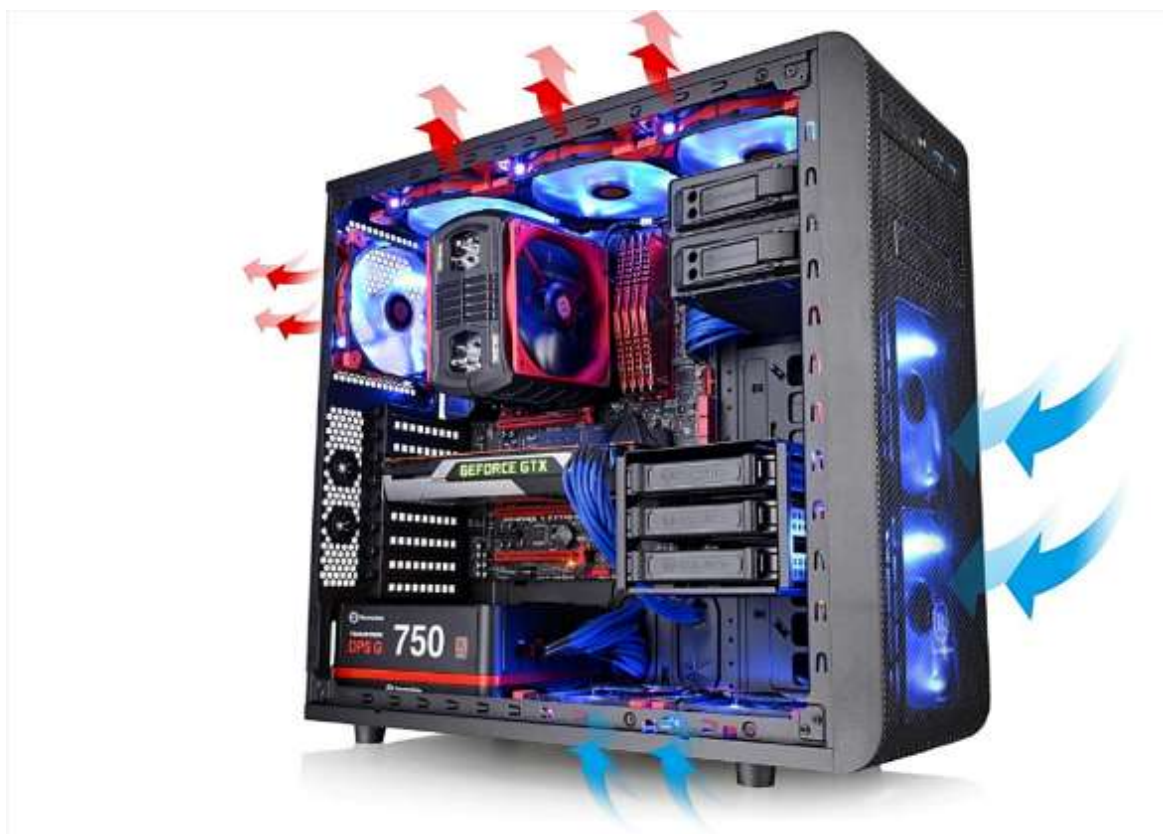
Система повітряного охолодження системного блоку комп'ютера
