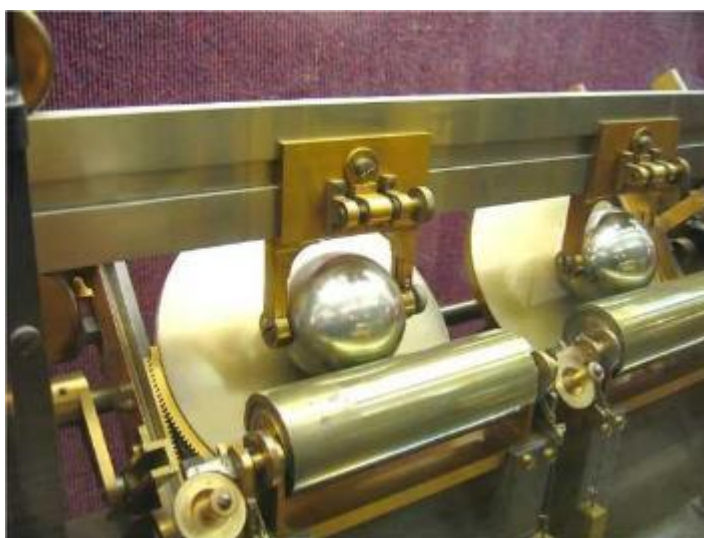
«Аналізатор гармонік» лорда Кельвіна, призначений для метеорологічних розрахунків
