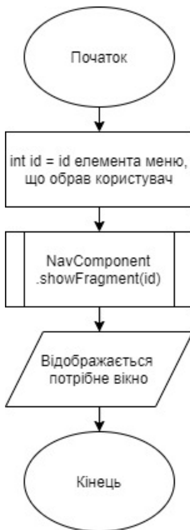
Рисунок 3.2 – Блок-схема відображення вікна через навігаційний компонент
