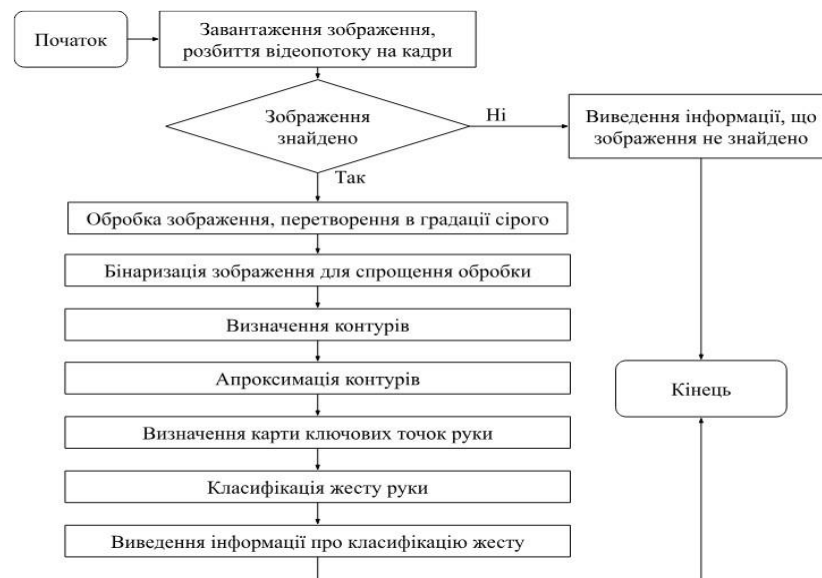
Рисунок 1 - Розроблений алгоритм розпізнавання жестів рук за допомогою бібліотеки комп'ютерного зору OpenCV
