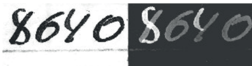
Мал. 10. Виявлення виправлення за допомогою ультрафіолетового випромінювача.
