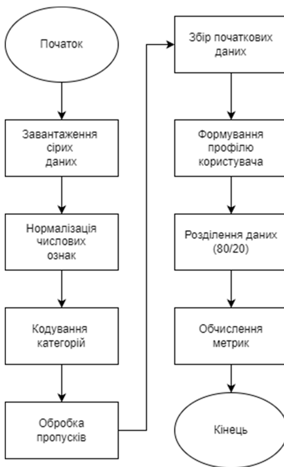
Рисунок 2.1 – UML діаграма обробки даних
