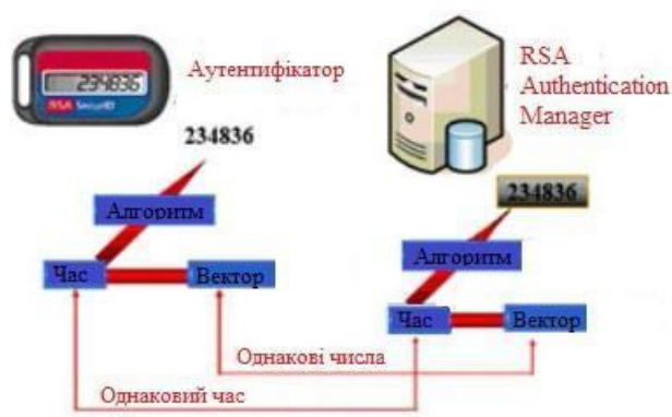
Рисунок 3.1 – Принцип роботи RSA Authentication Manager та токена.
