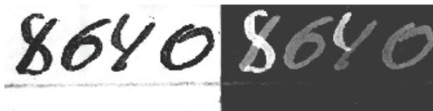
Мал. 10. Виявлення виправлення за допомогою ультрафіолетового випромінювача
