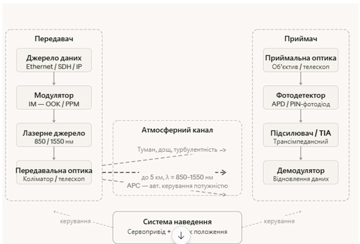
Рисунок 4.1 – Принцип побудови системи атмосферного оптичного зв'язку FSO
