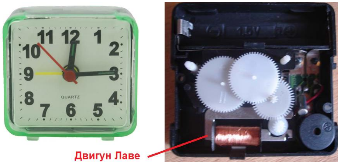
Рисунок 4 – Двигун Лаве в електромеханічному годиннику
