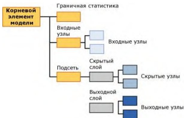
Рис. 10.4 – Схематична структура вмісту моделі, що базується на методі штучних нейронних мереж [3]
