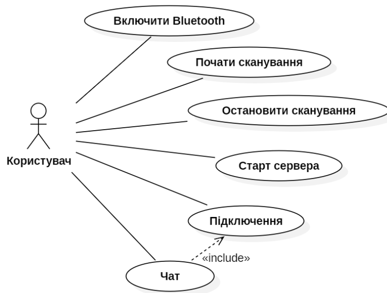
Рисунок 1.7 – Use case діаграма застосунку для актора Користувач
