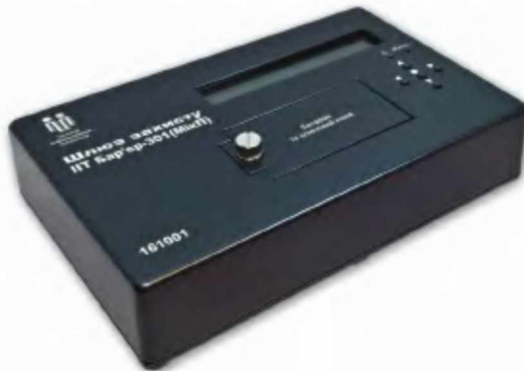
Рисунок 5.18 – Шлюз захисту “Бар’єр-301” мікро (швидкість шифрування – 40 Мбіт/с, кількість автентифікації клієнтів – 10 автентифікації/с)
