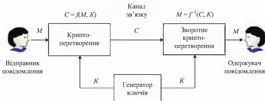
Рисунок 4.1 – Структурна схема криптосистеми з секретним ключем
