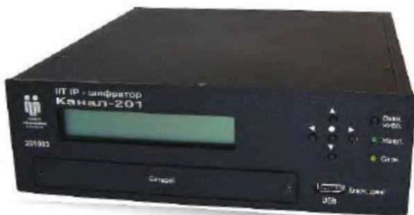
Рисунок 5.13 – ІП-шифратор “Канал-201” (швидкість шифрування – 125 Мбіт/с)
