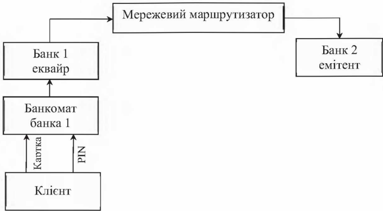
Рисунок 2.3 – Схема проходження інформації про PIN клієнта між банком-емітентом і банком-еквайром
