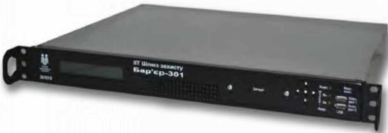
Рисунок 5.17 – Шлюз захисту “Бар’єр-301” (швидкість шифрування – 250 Мбіт/с, кількість автентифікації клієнтів – 100 автентифікації/с)
