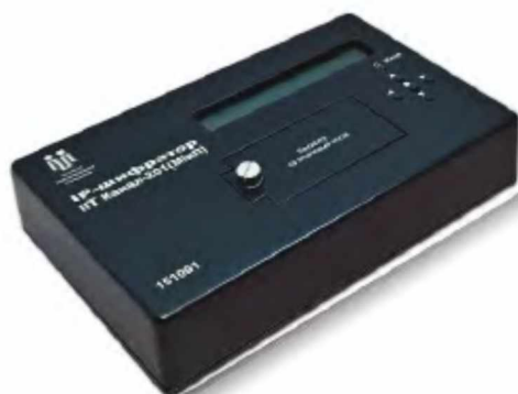
Рисунок 5.12 – ІП-шифратор “Канал-201” мікро (швидкість шифрування – 40 Мбіт/с)
