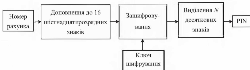
Рисунок 1.3 – Схема виведення PIN з номера рахунка користувача
