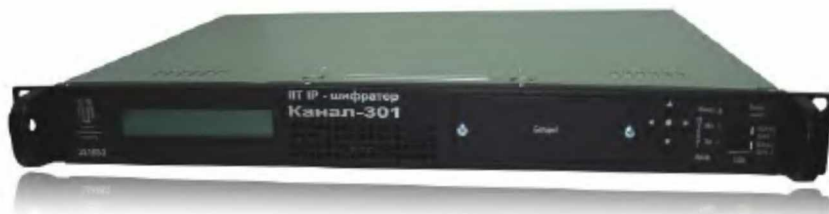
Рисунок 5.14 – ІП-шифратор “Канал-301” (швидкість шифрування – 1 Гбіт/с)
