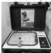
Фото 1.14. Мобільна цианоакрилатова камера
