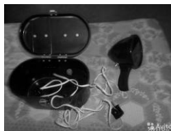
Фото. 1.5. Освітлювач для люмінесцентної діагностики ОЛД-41
