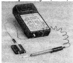
Фото 5.5. Прилад «Крапля» для експрес-аналізу дорогоцінних металів
