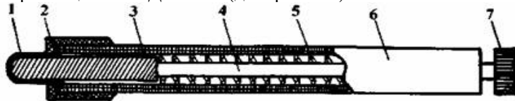
Рис. 1.4. Будова магнітного пензля: 1 - наконечник, 2 - гайка, 3 - постійний магніт, 4 - стрижень, 5 - пружина, 6 - корпус пензля, 7 - ручка
