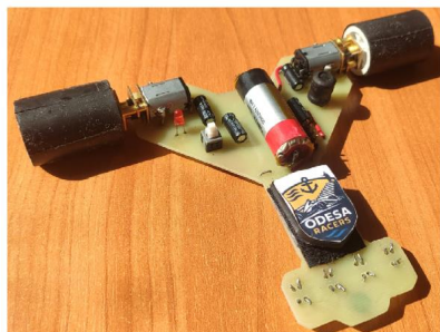
Рисунок 3 – Приклад використання цифрового контуру керування імпульсним підвищувальним перетворювачем
