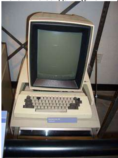
Рис. 2.1 – Xerox Alto став в 1973 р. першим комп'ютером, який використовував графічний інтерфейс користувача з манипулятором типу «миша» та мережу Ethernet
