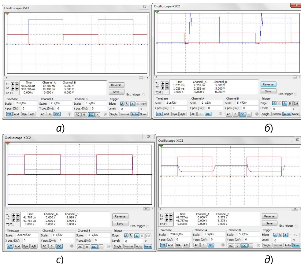
Рис. 3. Динамічні характеристики логічного інвертора: а) на біполярному ідеальному транзисторі; б) на біполярному реальному транзисторі; в) на МОН ідеальному транзисторі; д) на МОН реальному транзисторі.
