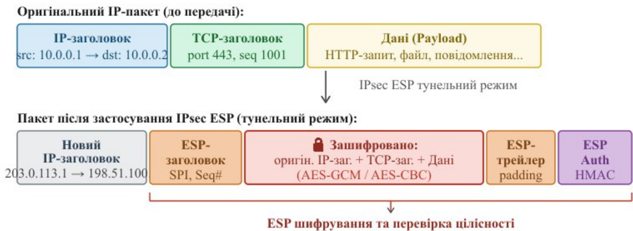
Рисунок 10.4 — Інкапсуляція IP-пакета в тунельному режимі IPsec ESP
