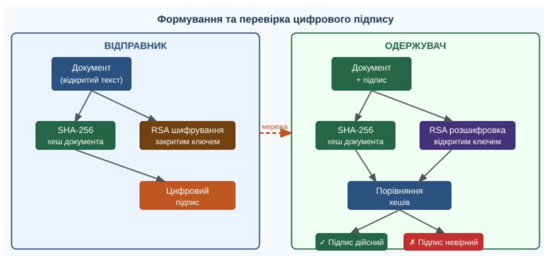
Рисунок 8.1 – Схема формування та перевірки цифрового підпису
