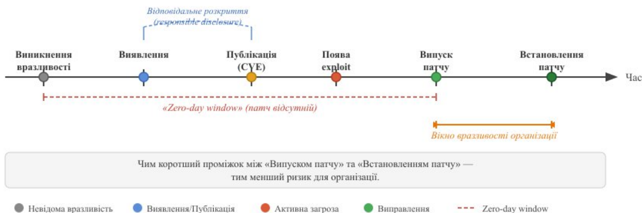
Рисунок 7.1 — Життєвий цикл вразливості від виникнення до усунення
