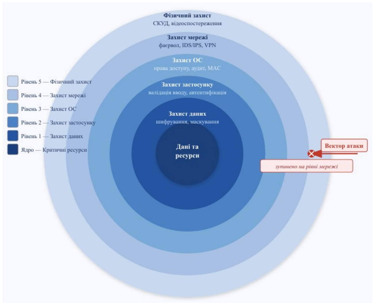
Рисунок 1.3 – Схема принципу Defense in Depth: ешелоновані рівні захисту
