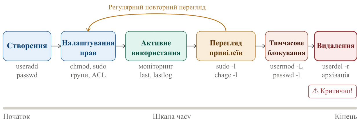
Рисунок 3.3 – Життєвий цикл облікового запису користувача
