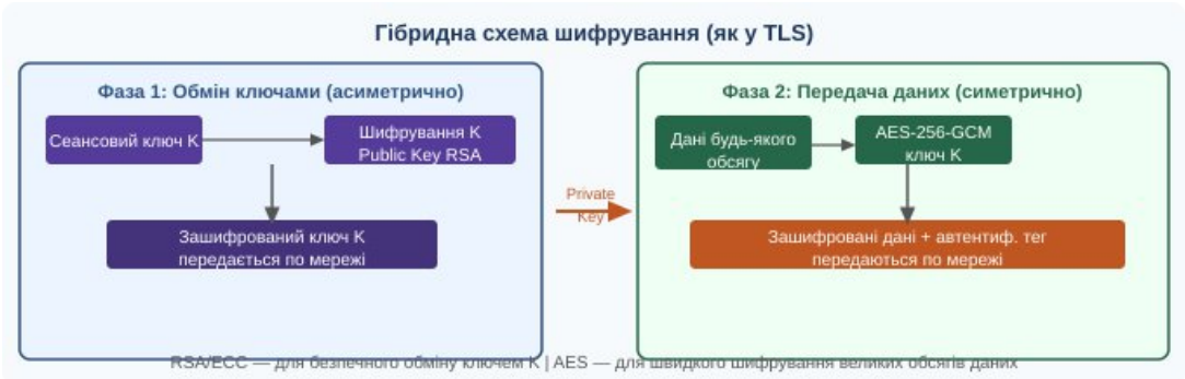
Рисунок 8.3 – Гібридна схема шифрування (на прикладі принципу TLS)
