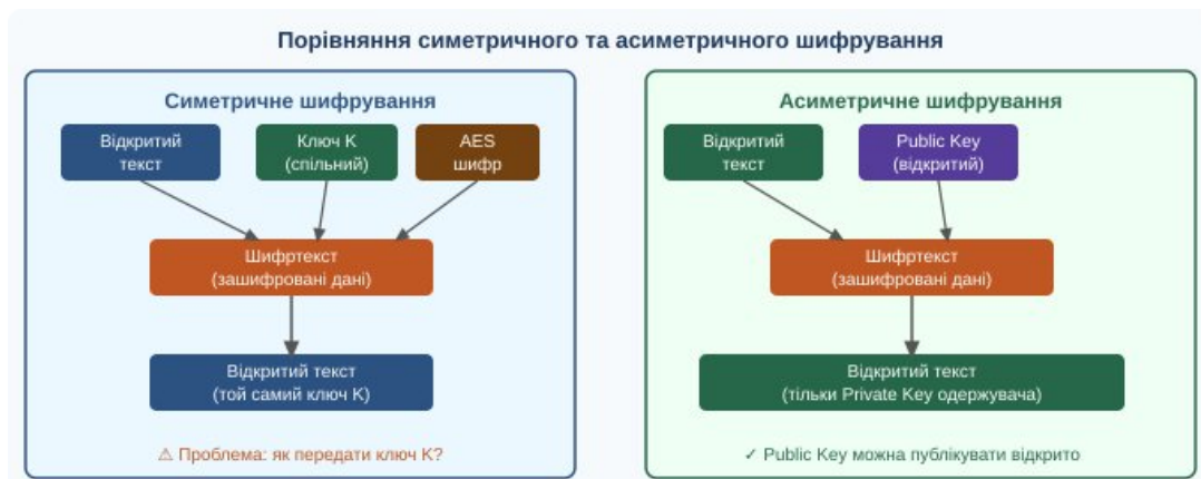
Рисунок 8.2 – Порівняльна схема симетричного та асиметричного шифрування
