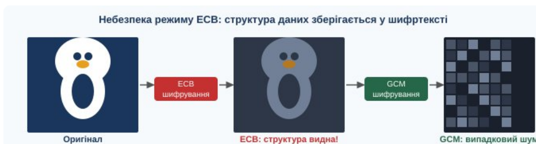
Рисунок 8.4 – Порівняння результатів шифрування у режимах ECB та GCM
