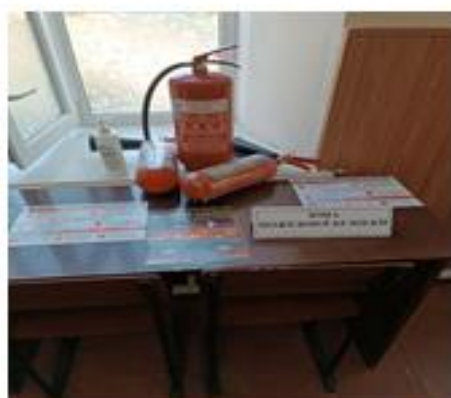
Порошковий і вуглекислотний вогнегасники
