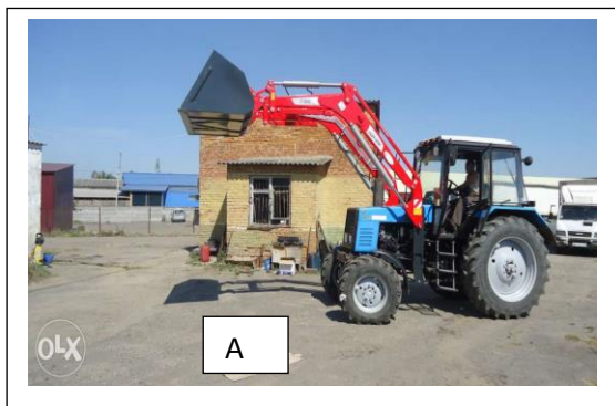
Рис. 4.3. Завантаження зерна у вантажний автомобіль за допомогою навісного обладнання до трактора з ківшом (А), а рулонів соломи – спец. штирем (Б)
