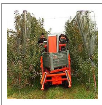
Рис. 8.2. Комбайн для індивідуального збору яблук
