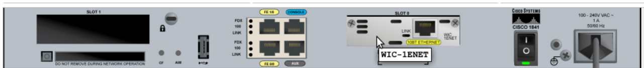
Рисунок 5.2 – Розміщення інтерфейсної плати WIC-1ENET у маршрутизатор Cisco 1841
