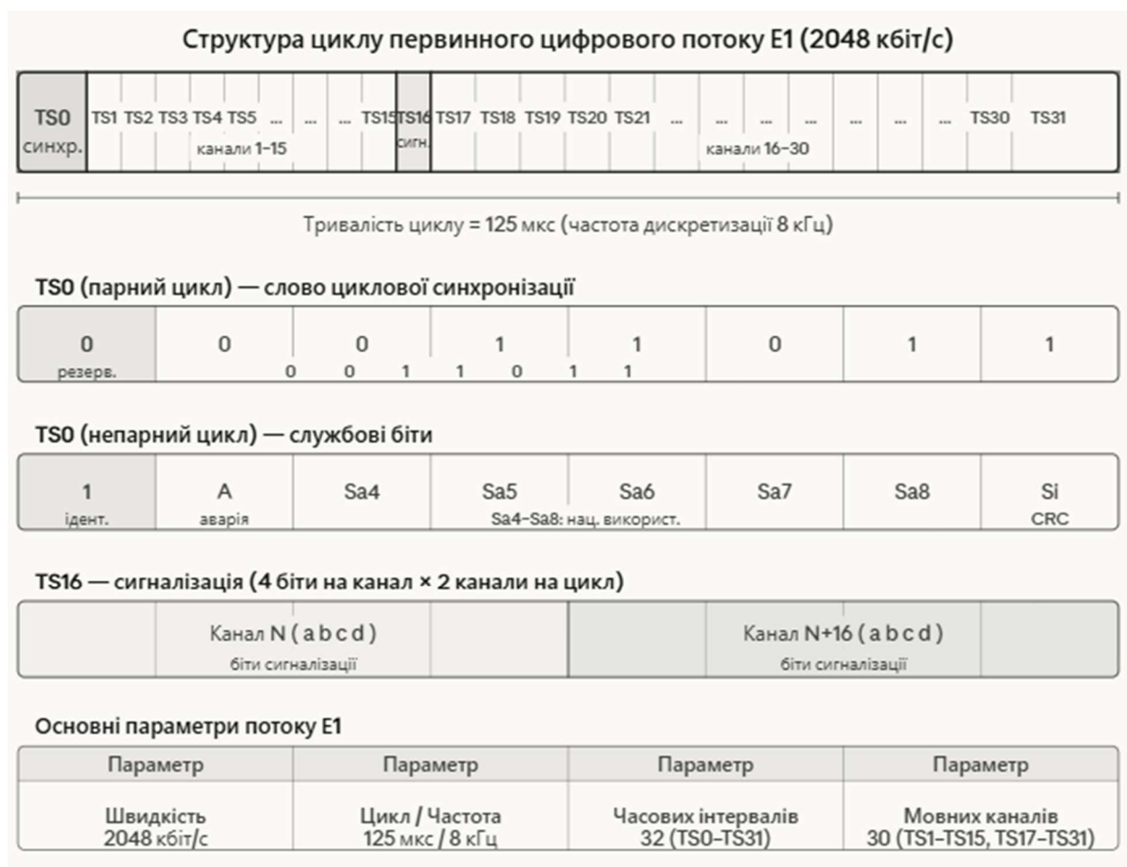
Рисунок 4.2 - Структура циклу первинного цифрового потоку E1
