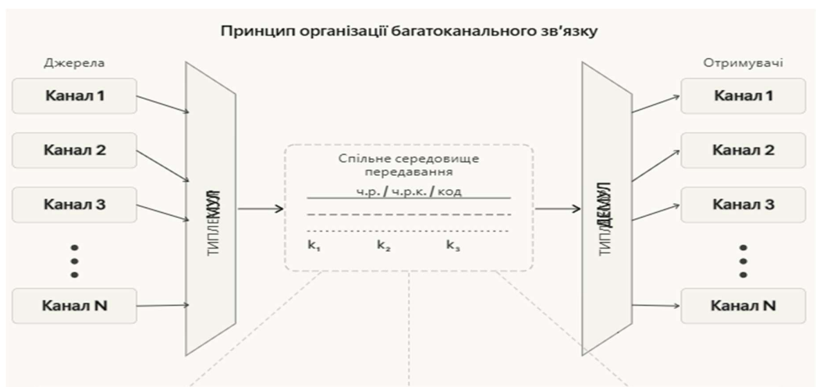
Рисунок 3.1 - Принцип організації багатоканального зв'язку
