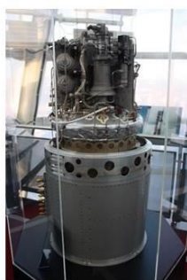
Водневий паливний елемент космічних кораблів Apollo, призначений для вироблення електричної енергії, тепла та води
