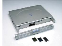
Метанольний паливний елемент для ноутбука (Casio) (2005 р.)
