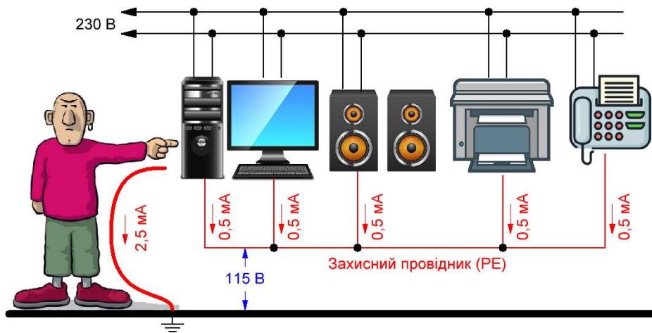
Рисунок 15 – Підсумовування стрів витоку обладнання класу I при непідключеному захисному проводі
