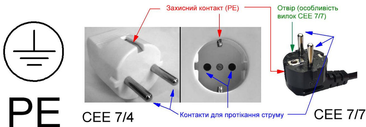
Рисунок 9 – Позначення захисного контакту обладнання класу I та електричні вилки типу CEE 7/4 та CEE 7/7 з трьома контактами
