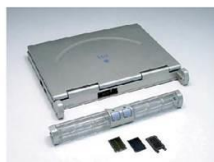
Метанольний паливний елемент для ноутбука (Casio) (2005 р.)
