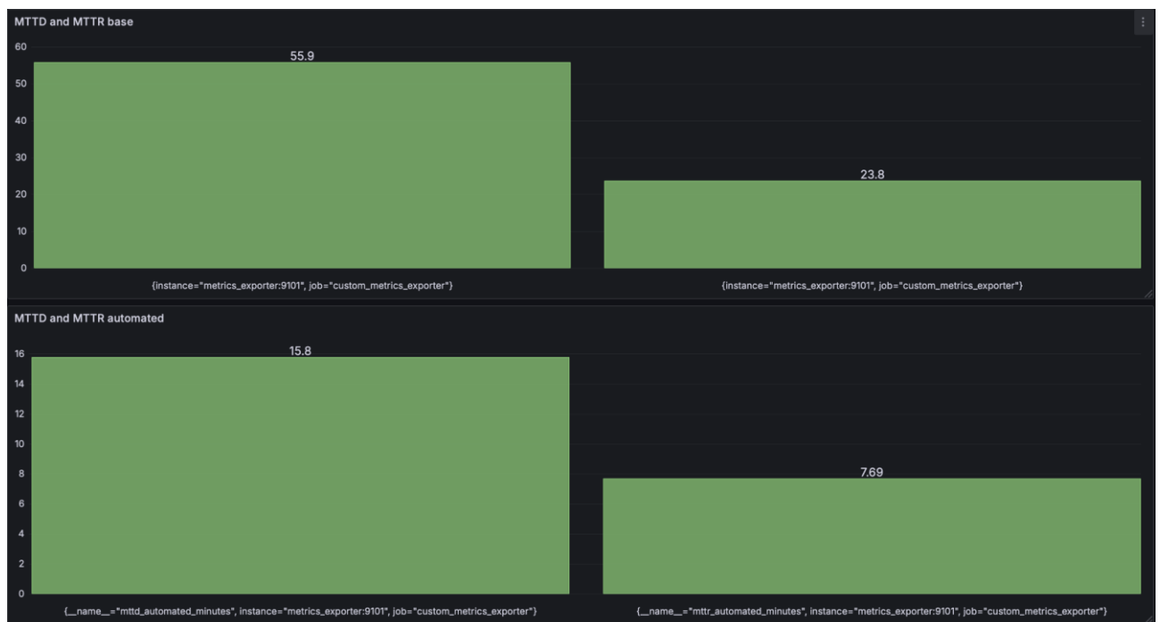
Рисунок 3.12 – Порівняння MTTD та MTTR між базовим і автоматизованим моніторингом
