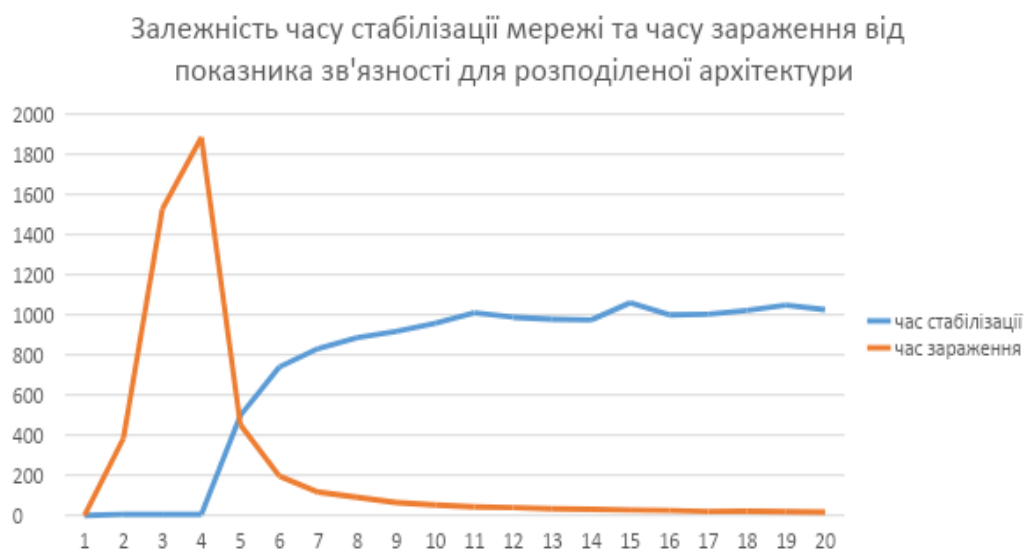
Рисунок 3.7 - Залежність часу стабілізації мережі та часу зараження від показника зв'язності для розподіленої архітектури
