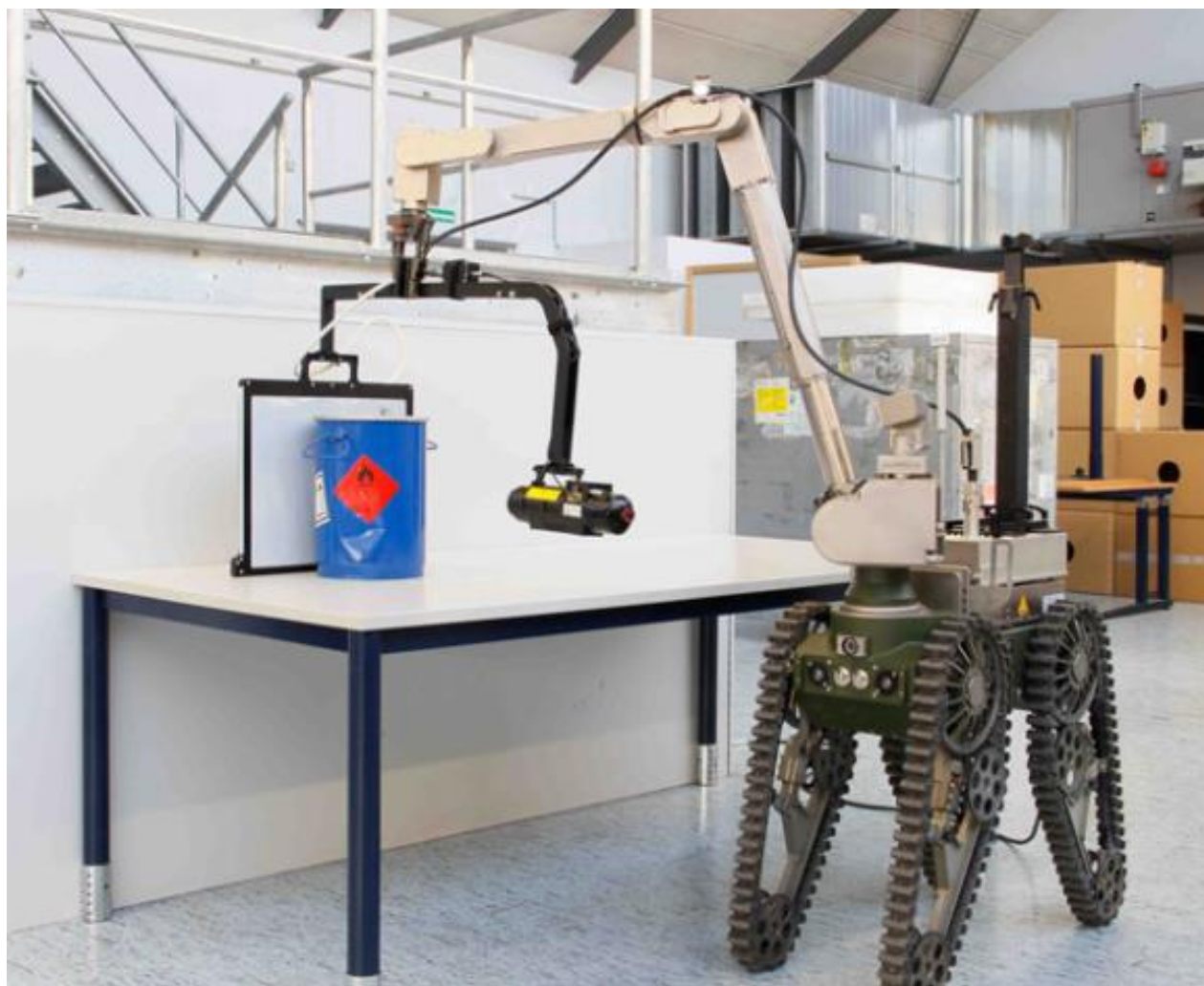
Фото 3. Telemax PRO проводить сканування предмета рентгеном 3
