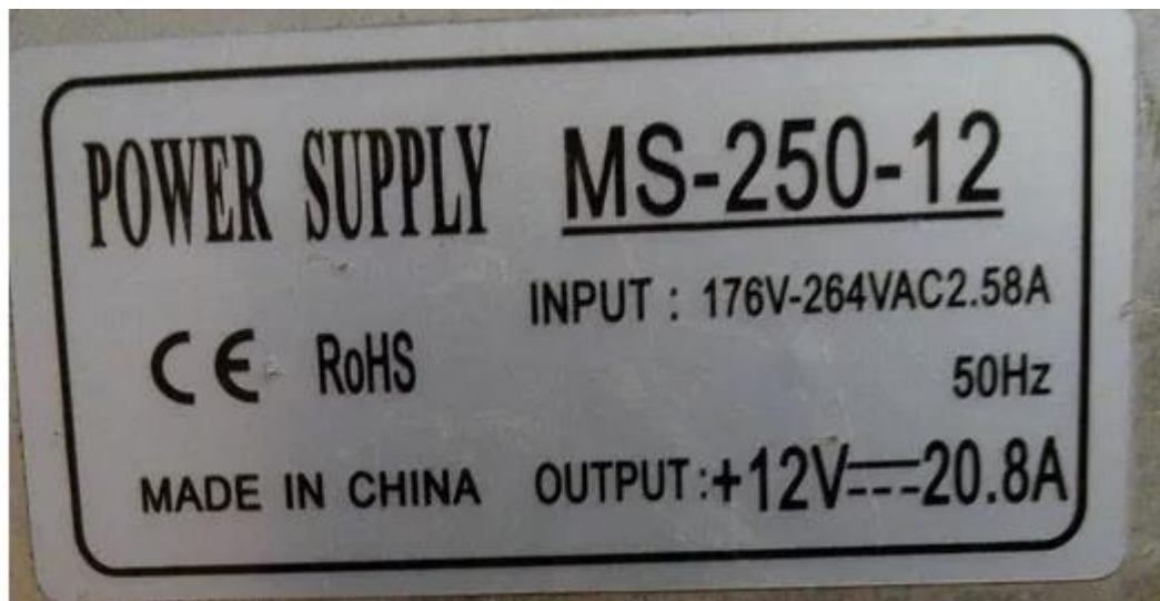
Рисунок 1 – Етикетка блока живлення із вихідною напругою 12 В та максимальним струмом 20,8 А (250 Вт)
