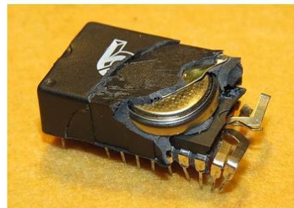
Мікросхема годинника реального часу із вбудованою літієвою батарейкою
