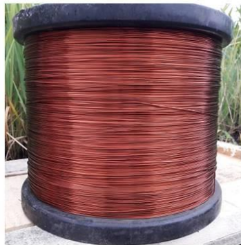
Емаль-провід – мідний або алюмінієвий дріт, вкритий тонким шаром емалі. Використовується для створення різноманітних індуктивних виробів
