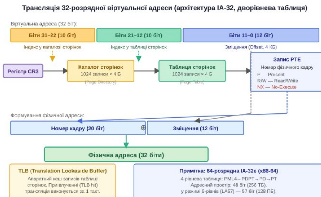
Рисунок 3.2 — Трансляція 32-розрядної віртуальної адреси (IA-32, дворівнева таблиця сторінок)
