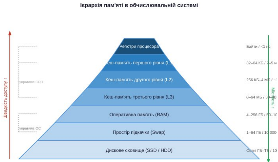
Рисунок 3.1 — Ієрархія пам'яті в обчислювальній системі
