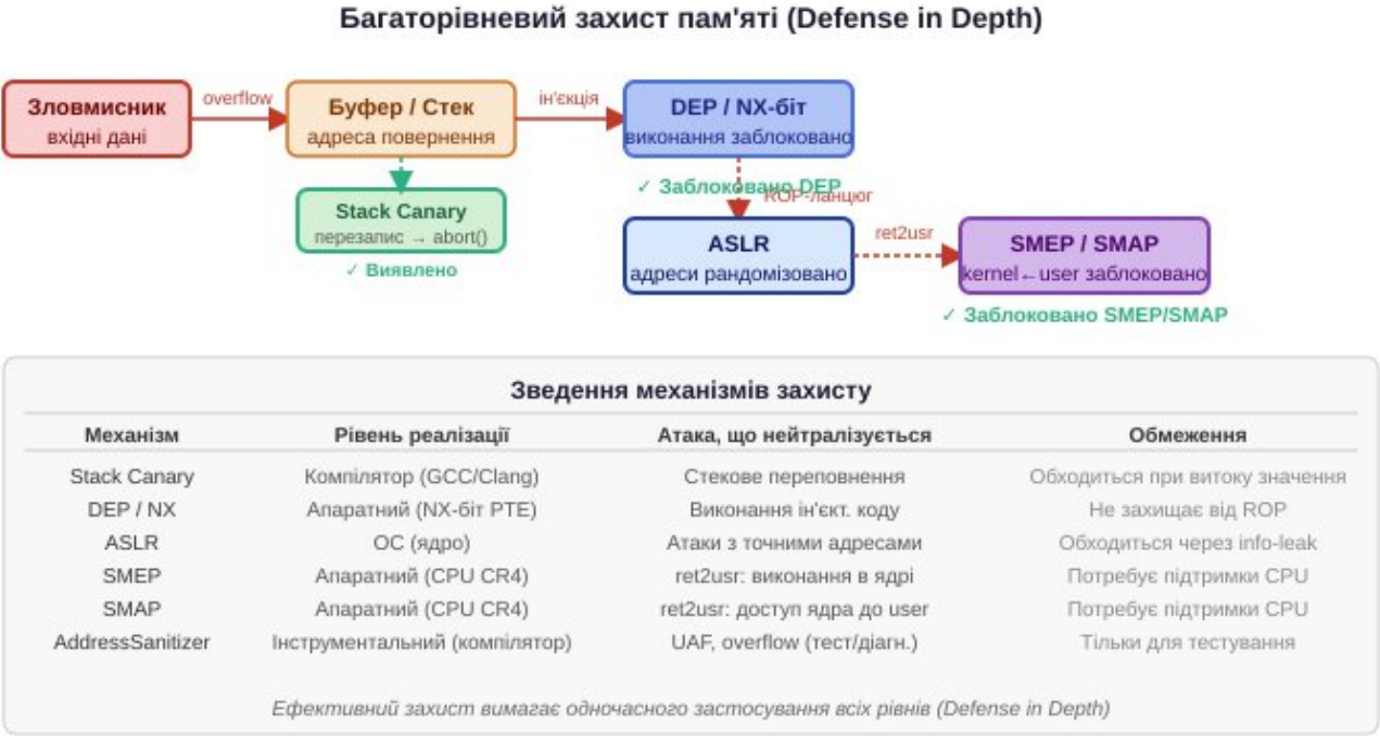
Рисунок 3.6 — Багаторівневий захист пам'яті (Defense in Depth)
