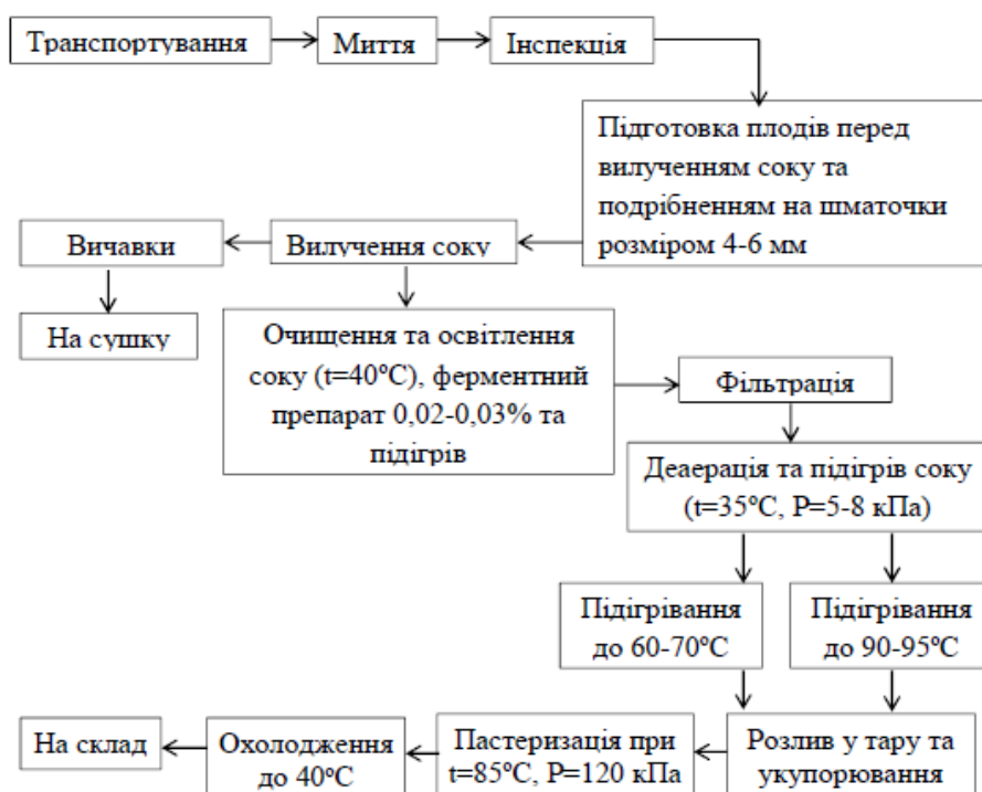
Рис. 2.2 Технологічна схема виробництва соку яблучного освітленого
