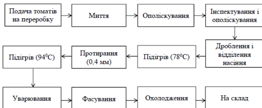
Рис.2. 3 Технологія виробництва концентрованих паст із томатів
