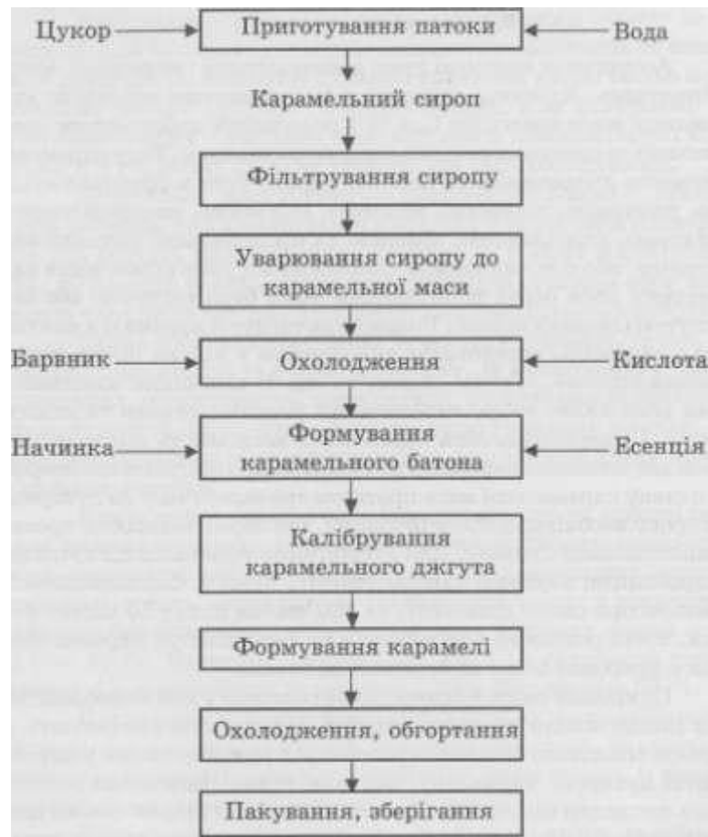
Технологічна схема виробництва карамелі
