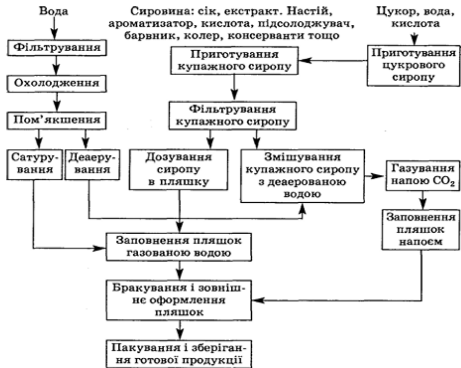
Рис.7.9 Принципова технологічна схема виробництва безалкогольного напою
